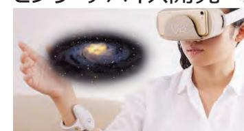
手指の動作を認識し、仮想空間内でジェスチャ入力するためのセンサシステム
