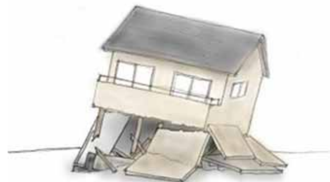
（基礎及び1階部分が崩れた住宅）
