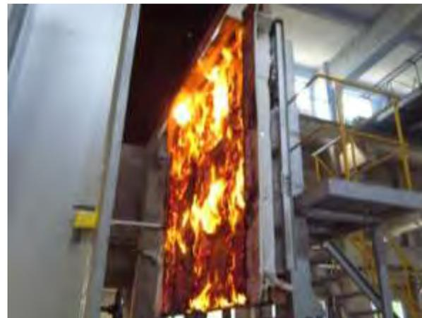
外壁の加熱試験(脱炉後の状況)
