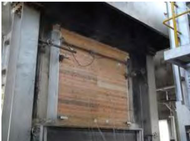
外壁の加熱試験(加熱中の状況)
