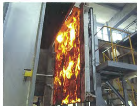
外壁の性能評価試験(脱炉後の状況)
