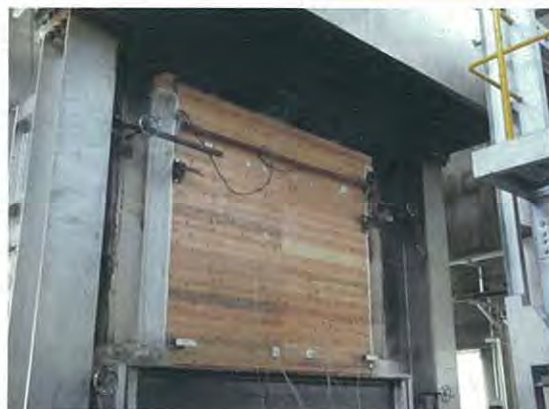
外壁の性能評価試験(加熱中の状況)
