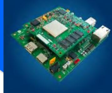
DMP DV700をFPGAに搭載しフレキシブルで低消費電力なAI推論処理モジュール
