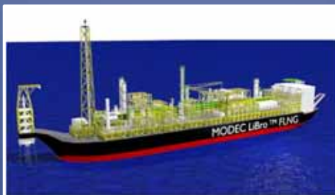
浮体式のLNG生産貯蔵設備
