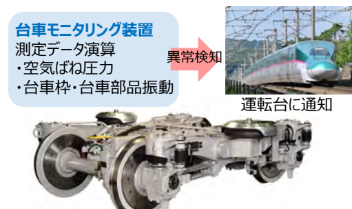
新幹線台車モニタリング
