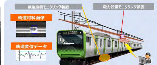
CBM（地上設備モニタリング）
