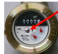
水を使用していない状態で水道メータのパイロットが回転する時は漏水しています
