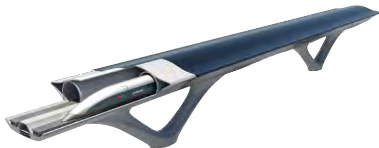
ハイパーループは、真空状態にしたチューブ中で磁力で浮遊させた車両を高速移動させる新たな交通システム。最高速度は理論上時速1000kmを超えるとされ、実現すれば、現在高速鉄道で約3時間20分を要するパリ-アムステルダム間を約30分で結ぶとされる。
