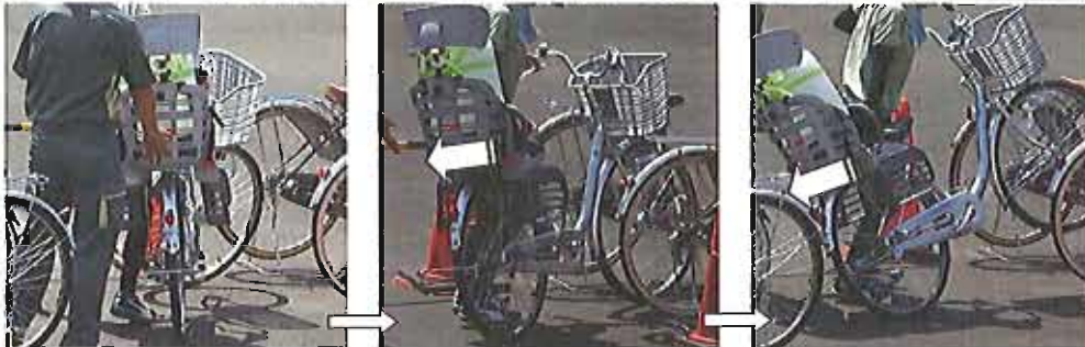
写真4. 急にハンドルをきり、後席が倒れこんだ様子（③-2、矢印の方向に倒れこんでいる）
