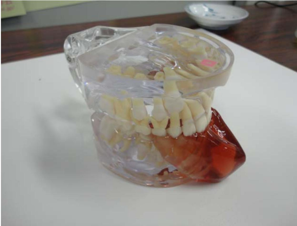
小児用モデルおよび成人用モデルで歯列前部に食品を設置し、咬合時の圧力を測定。噛み切り後の食品の分離状況を確認
