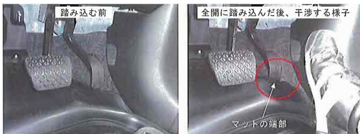
写真9 市販マット (A) の端部に干渉した例 (No. 20)
