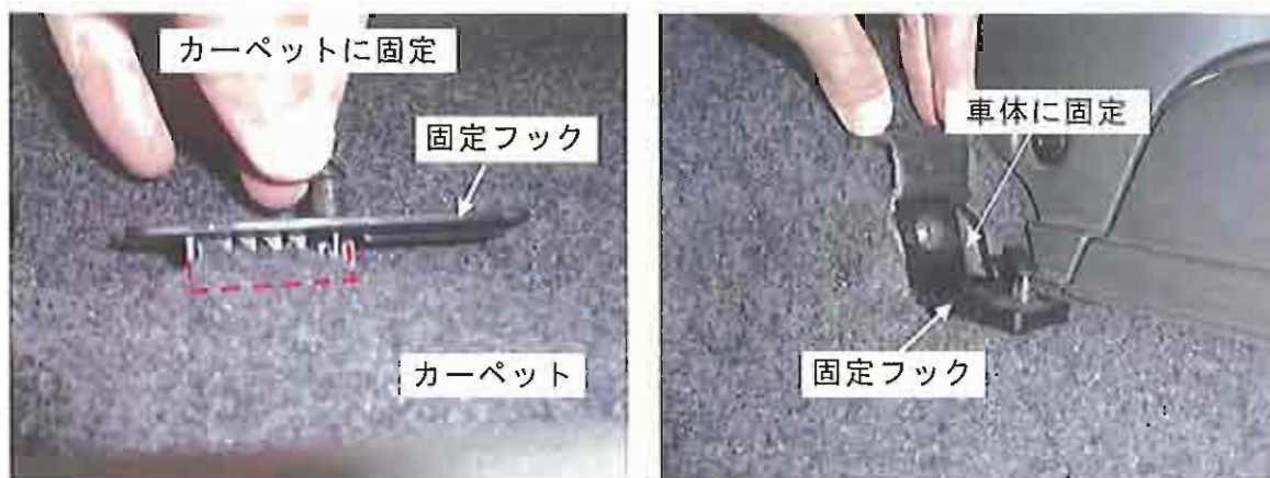
写真5 固定フックが外れなかった車種の車両側との固定の例 (No. 22)
