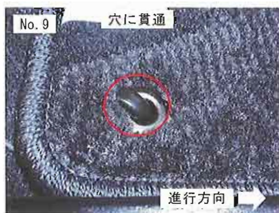
写真3 マット側の固定状態の例
