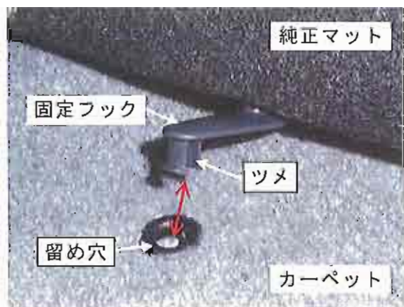
写真4 車両側との固定フックが外れた (No. 10)
