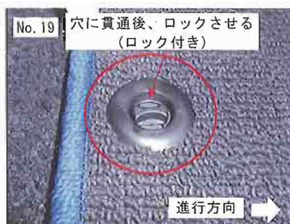
写真3 マット側の固定状態の例
