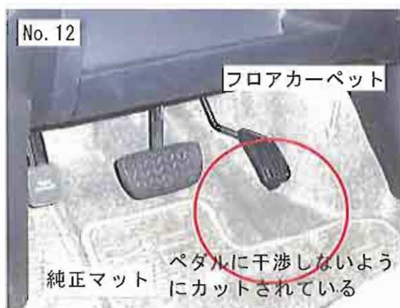
写真3 マット側の固定状態の例
