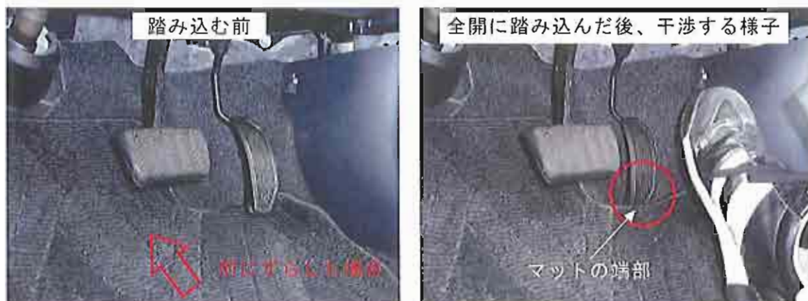
写真8 固定していない純正マットがずれた場合、マット端部に干渉した例 (No. 9)
