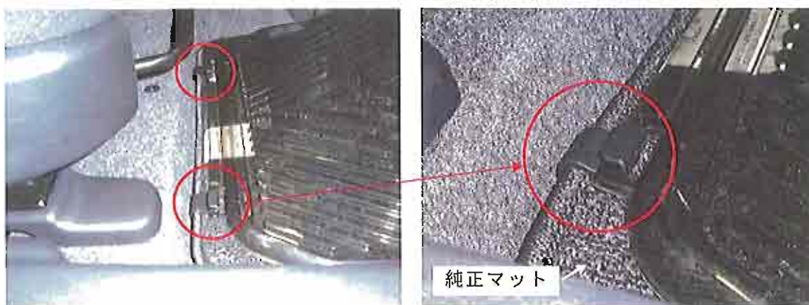
写真7 純正マットに固定する市販マット(D)
