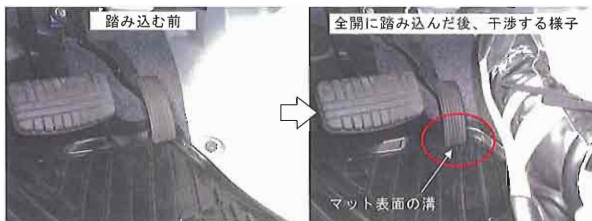
写真10 市販マット (D) 表面の溝に干渉した例 (No. 22)
