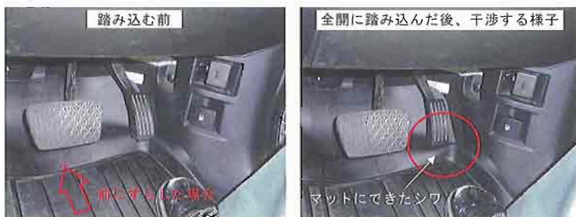
写真11 市販マット(B)がずれた場合にできたシワに干渉した例(No. 21)
