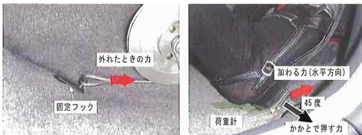
写真14 固定フックの取り付け強度と足に加わる力の測定の様子
