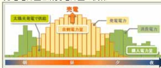
○発電電力が消費電力を上回った場合は、電力会社へ逆に送電して電気を買ってもらうことができる。反対に、夜間や曇り、雨の日など発電電力では足りない時は、従来通り電力会社の電気を使う。
