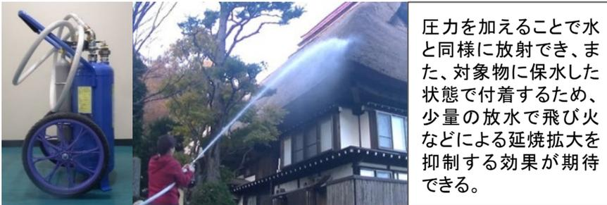
圧力を加えることで水と同様に放射でき、また、対象物に保水した状態で付着するため、少量の放水で飛び火などによる延焼拡大を抑制する効果が期待できる。
