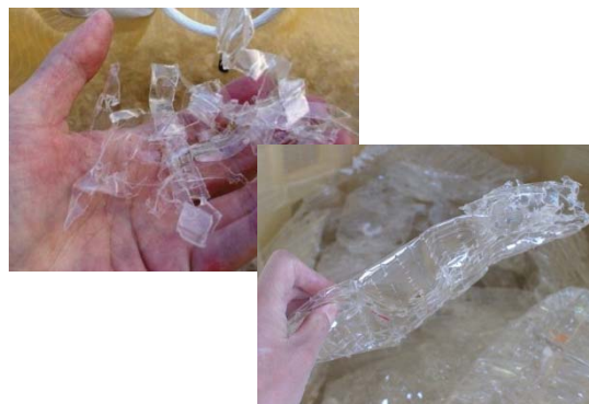
スーパーマーケット (自動回収機)の回収品(破碎・圧縮)
