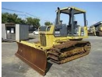
＜ブルドーザー＞ （廃棄物の選別・投入、盛土、整地に使用）
