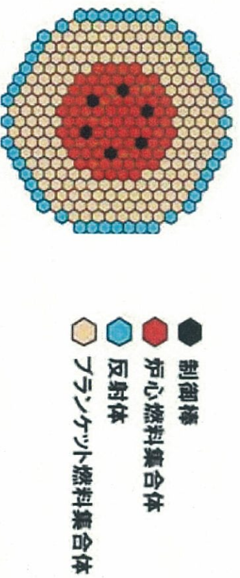
図 A-1 「常陽」MK-1 炉心の水平断面図
