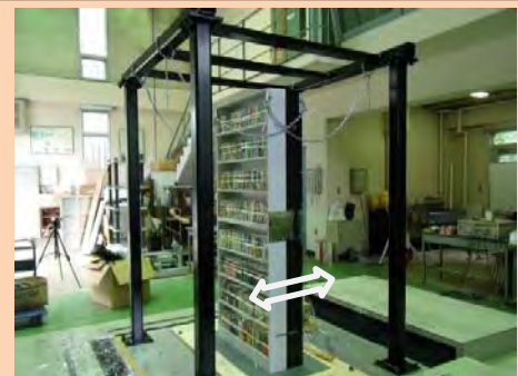
本棚の転倒に関する振動実験
