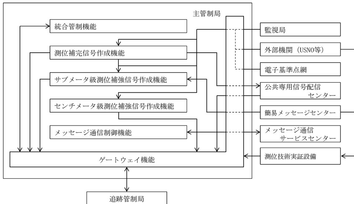
図 5.3.2-1 主管制局の機能ブロック図例
