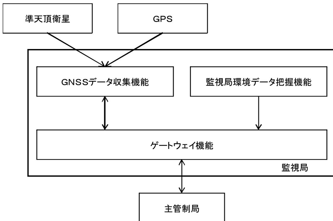
図 5.3.4-1 監視局の機能ブロック図例
