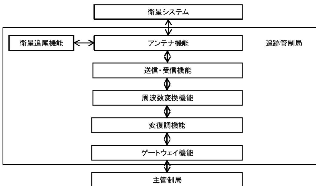
図 5.3.3-1 追跡管制局の機能ブロック図例
